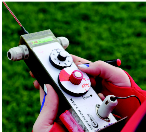
Obr. 3. Toto je přijímač pro pásmo KV 3,5 MHz (80 m) typu SUPERFOX 3,5GX. Je to superhet s dvojitým směřováním, anténa je symetrická feritová v kombinaci s prutovou. Pracuje v rozsahu 3,48 až 3,71 MHz a je napájen z vestavěného NiMH akumulátoru 7,2 V/320 mAh. V posledních letech vyrábí OK2BWN asi 100 ks přijímačů od každého typu ročně, exportoval je už do 35 různých zemí. Největšími odběrateli jsou ČR, následuje Japonsko, Švédsko, Slovensko, Rusko, Slovinsko atd.
