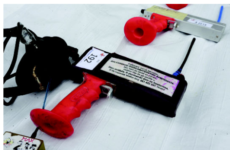
↑ Obr. 6. Někteří závodníci ROB používají přijímač s rukojetí. Tento přijímač je slovinský pro pásmo 80 m
